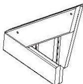
WP09 | MONTAJE DEL PANEL IZQUIERDO SUPERIOR FRONTAL -W2A03296 (x1) | 1 1/4"x10 1/4"x5 7/8" (32x261x290)
